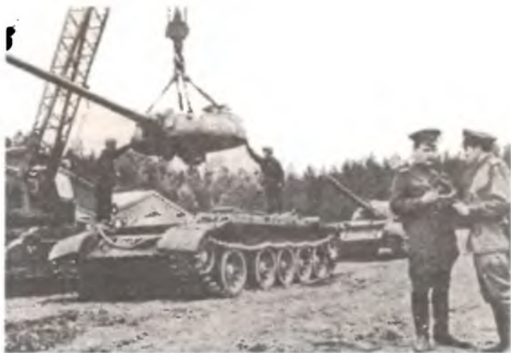
Обезбашенный. Ремонт Т-54 в поле
